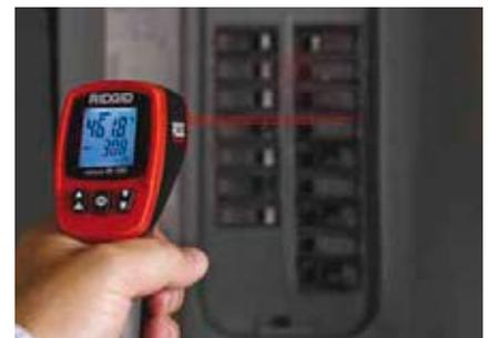
Compruebe los fusibles o circuitos por si existe sobrecalentamiento, lo cual podría estar causado por circuitos sobrecargados
