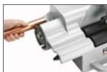
El cepillo limpiador de D.E. para servicio pesado limpia rápida y fácilmente el diámetro exterior de los tubos de cobre de ½" o 2" (12 - 54 mm)
