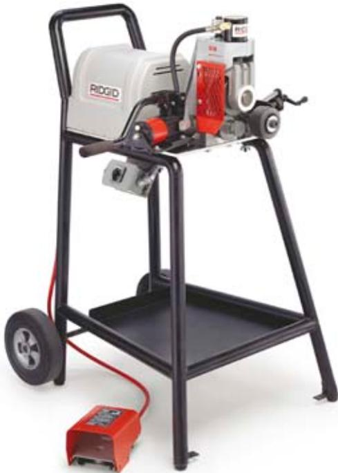
La máquina para ranurado de rodillo RIDGID® modelo 918-I es capaz de ranurar tubos de 1" a 8" Schedule 40 y de 1" a 12" Schedule 10 más rápido que ninguna otra máquina de ranurado de rodillo en su clase. Alimentado por un motor universal de 1.2 HP y una transmisión para servicio pesado, el modelo 918-I produce ranuras de alta calidad de manera consistente y sin esfuerzo.
