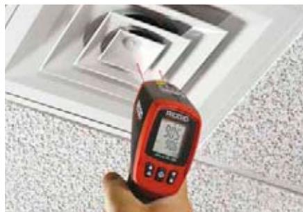
Mida la eficiencia de la disipación de calor para revelar y localizar pérdidas térmicas en sistemas de flujo
