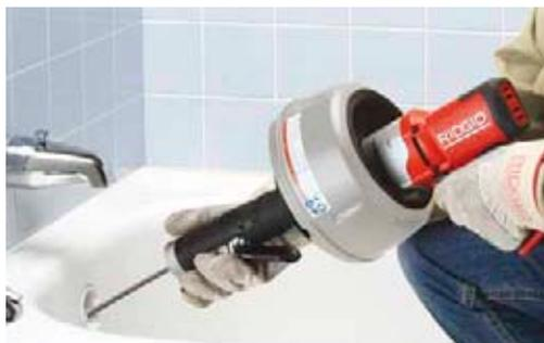
El modelo K-45AF despeja rápidamente acometidas de bañera obturadas. Avance y recupere cable sin invertir el motor
